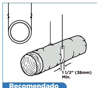
Figura 8 - Soportes con espesor mínimo de 38mm.
