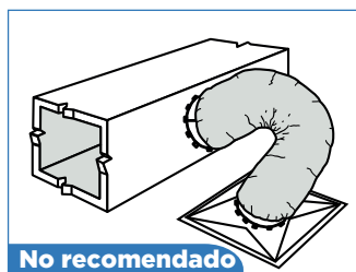
Figura 2 - Longitud excesiva y radio de giro estrecho incrementan la caída de presión y afecta el flujo de aire.
