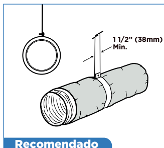
Figura 7 - Soportes con espesor mínimo de 38mm.
