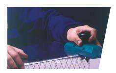
Herramientas de corte a 22,5° y 90°, que se usan sobre el ducto recto para transformarlo en figuras por el Método del Tramo Recto (MTR). Debido a su especial configuración, realizan un corte limpio y preciso, con la inclinación adecuada en cada caso.
