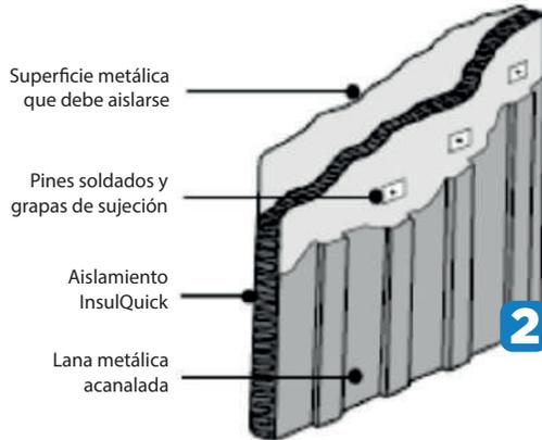
1. Dependiendo de la viabilidad de aplicar soldadura sobre los tanques, suelda a la pared del equipo pines o studs.
